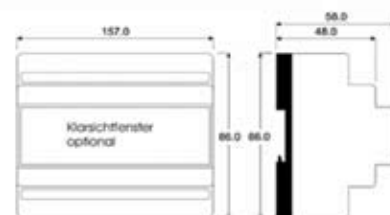
Hutschienenmontage DIN EN 60715 (TH35) Maße: L/B/H 157/86/58mm-9PE
